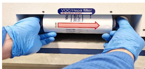
Abbildung 12.2 Verfahren zum Einsetzen und Entfernen des LCKW/HEPA-Filters
