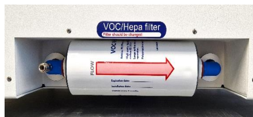
Abbildung 12.3 Korrekt installierter LCKW/HEPA-Filter
