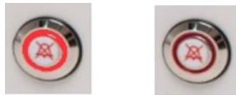
Abbildung 14.11 Alarmtaste, die den Alarmzustand anzeigt
