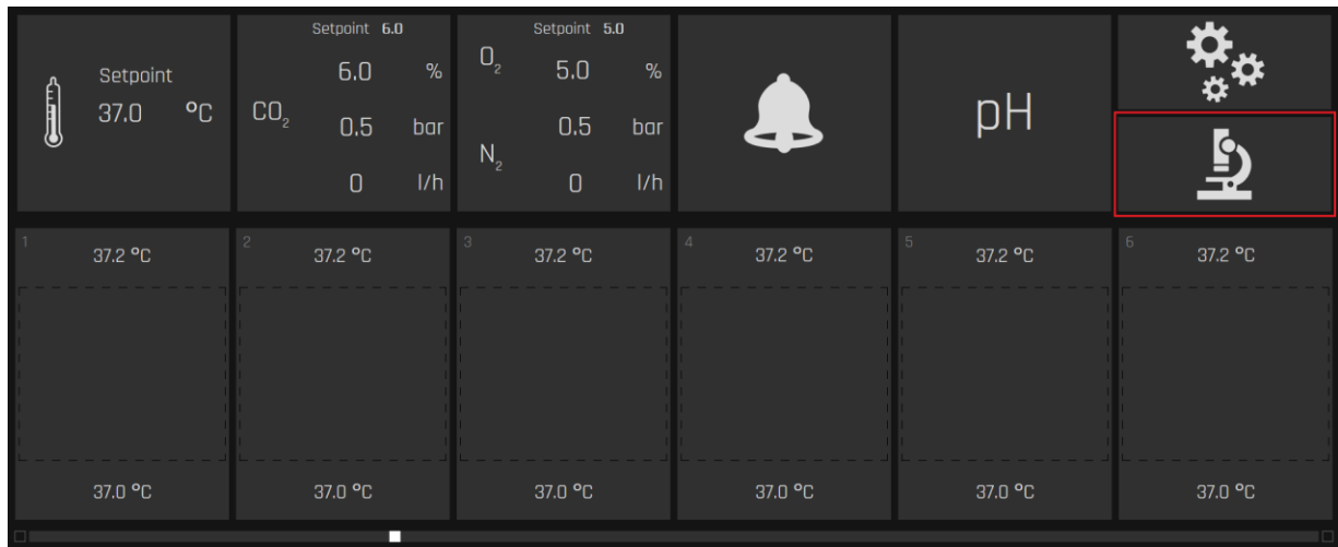
Abbildung 20.30 Schaltfläche für den LiveView-Modus auf dem Bildschirm des Mehrraum-IVF-Inkubators MIRI® TL6 oder MIRI® TL12
